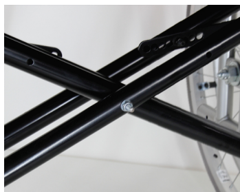
Estrutura dobrável em X duplo reforçado.
