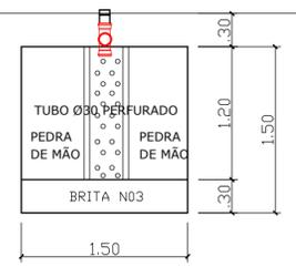
**DETALHE DO FILTRO ANAERÓBIO**
