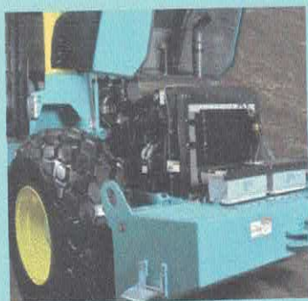
Acesso ao compartimento do motor e localização da bateria
