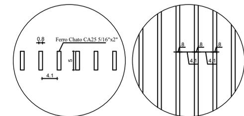
**Detalhe da Armação da Grade de Captação**
